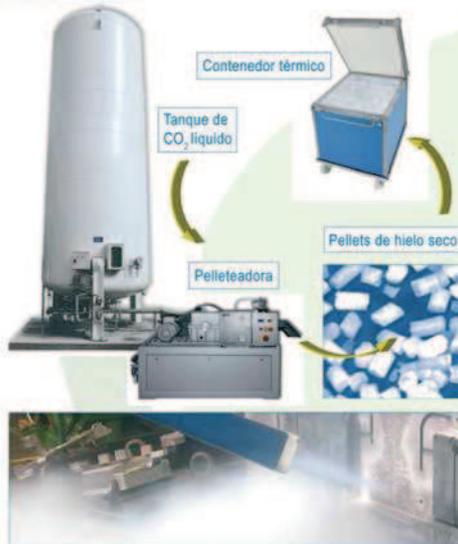
La limpieza criogénica, utilizada hasta la fecha en descontaminación nuclear, se implanta frente a cualquier otro sistema empleado en la actualidad, por su efectividad productiva y eliminación de costes añadidos.
